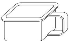
Ausführung in CNS, GN-Schale mit Haltegriff, kippbar. Gewürzschütten werden unter ein vorhandenes Bord eingeschoben, welches CNS-geschlossen sein muss! In der Entnahmestellung 30° gekippt zum leichteren Zugriff. Tiefe: 100 mm
