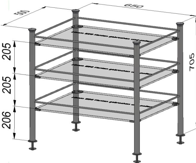
Reling aus Vollmaterial  $\varnothing$  10 mm links und rechts hinten; Steher aus Rundrohr  $\varnothing$  30 x 1,5 mm; 4 x Zierkappe konisch.
