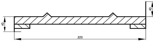
Ausführung komplett in CNS, zur Verstärkung und Entdröhnung mit wasserfester Spanplatte unterleimt, mit zwei eingepressten Sicken zur Tabletauflage, inkl. Konsolen; Breite 320 mm
