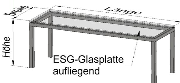
1-etagig aus CNS-Rahmen und Glasbordfläche, zur Montage werden Anschraubklötze mit Befestigungsmaterial mitgeliefert. 350 mm hoch.
