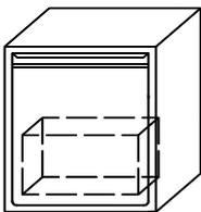
Unterbau-Hygiene 2-Schrank, frontseitig eine Überauszug-Schublade mit einem hineingestellten Abfallbehälter aus CNS. Abfallbehälter niedriger zum Einbau unter ein Becken. Auf Wunsch zwei Behälter möglich => Mehrpreis 64521.
