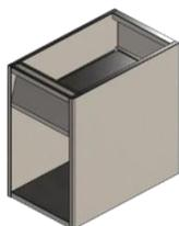
Unterbauschrank zum Einbau unter ein Gerät, z.B. Grillplatte. Vorne eine demontierbare Schalterblende, darunter offen. Dach je nach Einbaugerät. Mehrpreis für Fettlade oder Auffangschale, je nach Gerät.
