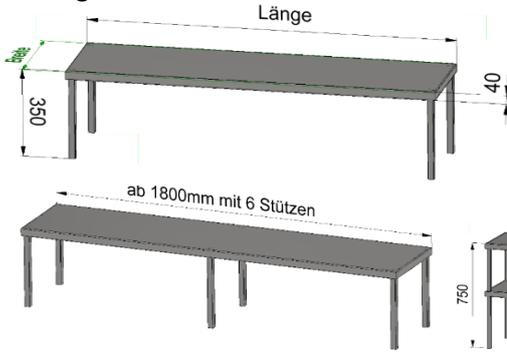
aus CNS, zur Montage werden Anschraubklötze mit Befestigungsmaterial mitgeliefert.
