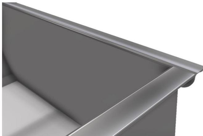
Die Schubladen sind dynamisch bis zu 53 kg belastbar. Durch den Überauszug können die Gastronormbehälter frei nach oben ohne Schrägstellung herausgenommen werden. Die Überauszüge bestehen aus dem Werkstoff 1.4509 (CrTiNb18) mit Massiv-Kunststoffrollen, beidseitig seitenstabil, abkippsicher, laufruhig, mit gedämpften Anschlägen und Selbsteinlauf.
