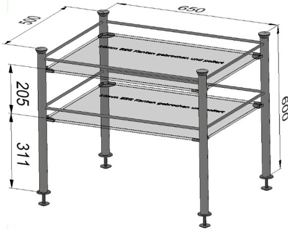
Reling aus Vollmaterial  $\varnothing$  10 mm links und rechts hinten; Steher aus Rundrohr  $\varnothing$  30 x 1,5 mm; 4 x Zierkappe konisch;
