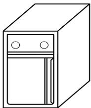
Unterbau-Hygiene 2-Schrank, frontseitig oben eine demonstrierbare Schalterblende, darunter eine Flügeltür. Dach je nach Einbaugerät. Mehrpreis für Fettlade oder Auffangschale, je nach Gerät.
