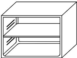
Unterbau-Hygiene 2-Schrank, frontseitig offen. Im Schrankinneren 4 Paar eingepresste Sicken und ein höhenverstellbares Zwischenbord.
