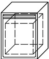
Unterbau-Hygiene 2-Schrank, frontseitig eine Klapptüre mit einem aushängbaren Abfallbehälter aus CNS.
