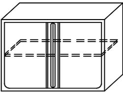
Unterbau-Hygiene 2-Schrank, frontseitig ein bzw. zwei Flügeltüren. Im Schrankinneren 4 Paar eingepresste Sicken und ein höhenverstellbares Zwischenbord.
