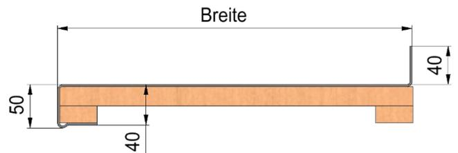
Standardausführung: Integrierte Tropfnase und Metallabdeckung des Oberplattenrücksprungs.
