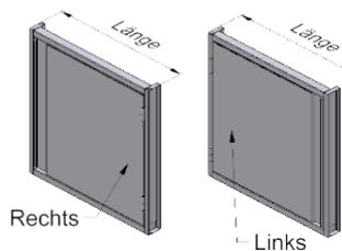
Einbaurahmen, geeignet zum Einbau zwischen zwei Elementen, mit einer Flügeltüre.
