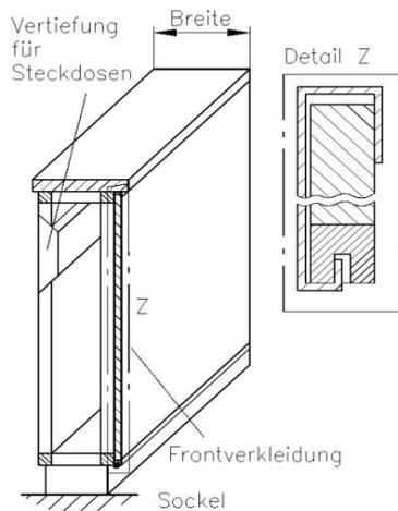
Rahmengestell sowie einseitige Verkleidung komplett aus CNS. Verkleidung einseitig abnehmbar mit Vertiefung für Steckdosen. Ohne Abdeckung und ohne Sockel.
