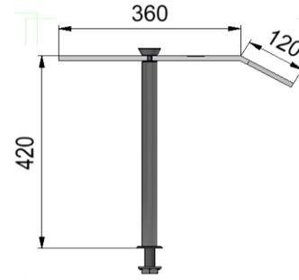
Steher aus Rundrohr  $\varnothing$  30 mm o. 4-Kantrohr, oben mit konischer Zierkappe geschlossen; ESG-Glas 10 mm stark; Preis ohne Zusatzfunktion (Anbauteile für Aufsätze); Zusatzfunktionen siehe Anbauteile für Aufsätze
