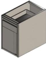
Unterbausschrank, vorne eine bzw. zwei Schublade(n), darunter eine bzw. zwei Flügeltüre(n). Im Schrankraum ein Zwischenbord. Bei Schrankhöhe über 560 mm ist das Zwischenbord höhenverstellbar. TTSC 867 mit zwei Laden und zwei Türen.
