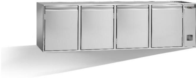
Ausführung im Standard mit vier Türen (AL oder AR). Inklusive R134A E-Ventil montiert für Normalkühlung oder R452 E-Ventil für Tiefkühlung. Mit elektrischer Abtauung. Bauseitiger Tauwasserabfluss erforderlich.
