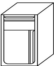
Unterbau-Hygiene 2-Schrank, frontseitig oben eingebaut eine Überauszug-Schublade (GN 1/1), darunter eine Flügeltüre.
