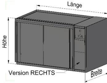
Hygiene 2 Unterbauwärmeschrank, vorne mit zwei Schiebetüren. Innen ein höhenverstellbares Zwischenbord.
