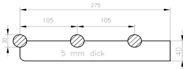
Rohre und Konsolen aus CNS, Ausführung standardmäßig mit Rohren  $\varnothing$  30 mm und Rohrabschluss mit Plastikabdeckung.
