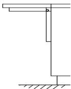
Ausführung abklappbare Abdeckung, unten CNS geschlossen; Bord pro lfm ohne Konsolen; mind. 2 Stk/m!
