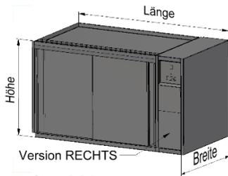
Hygiene 1 Unterbauwärmeschrank, vorne mit zwei Schiebetüren. Innen ein höhenverstellbares Zwischenbord.
