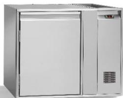
Ausführung im Standard mit einer Türe (AL oder AR). Inklusive R134A E-Ventil montiert für Normalkühlung oder R452 E-Ventil für Tiefkühlung. Mit elektrischer Abtauung. Bauseitiger Tauwasserabfluss erforderlich.
