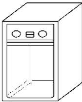
Unterbau-Hygiene 2-Schrank, frontseitig oben eine demonstrierbare Schalterblende, darunter offen. Dach je nach Einbaugerät. Mehrpreis für Fettlade oder Auffangschale, je nach Gerät.
