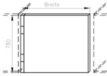
Türe beidseitig aus CNS, schalldämmend isoliert, mit Scharnier. Länge max. 900 mm.
