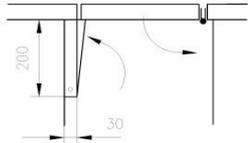
Klappe aus CNS mit CNS-Stangenscharnier und selbst-rastender Halterung.
